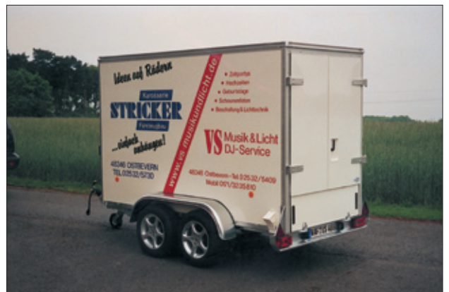
Leichtbaukoffer 3000 x 1450 x 1900 mm
