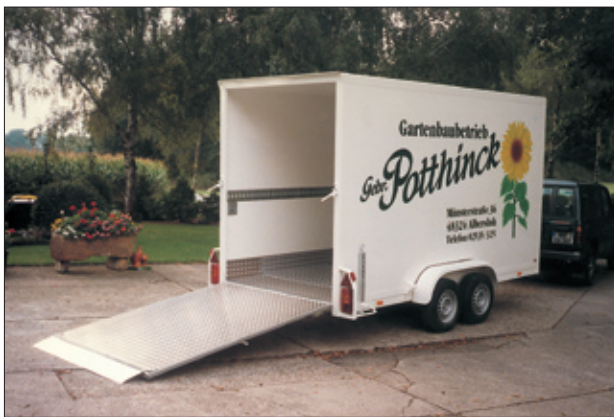
Kofferaufbau in isolierter Ausführung 4000 x 1850 mm für CC-Karren
