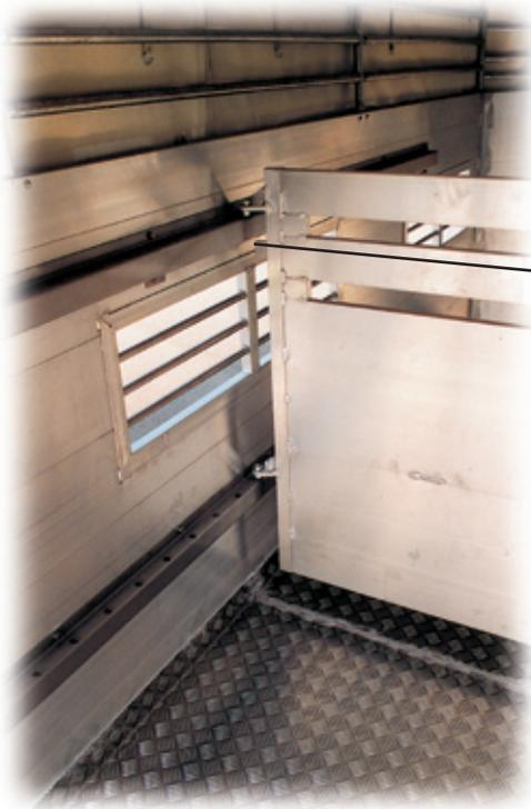
Trennwandlochschiene in V<sub>2</sub>a Profil mit 100 mm Raster Trennwand mit Sicherheitsverriegelungssystem
